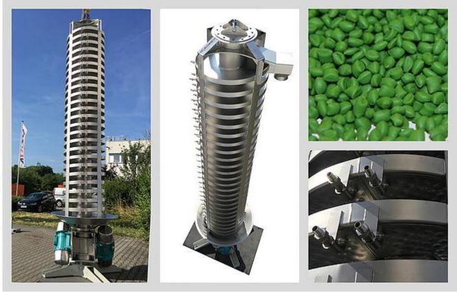
capacity (t/h): 2,5 | bulk: TPE-Granulat | density (t/m<sup>3</sup>): 0,5 bis 0,9 | grain size (mm): 2 - 5
