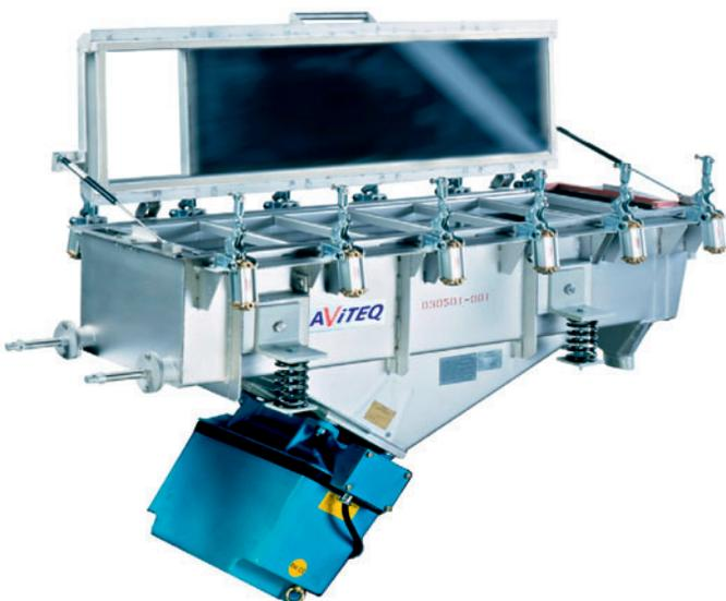
AViTEQ-Förderrinne mit Magnetvibrator und mitschwingender Abdeckung
