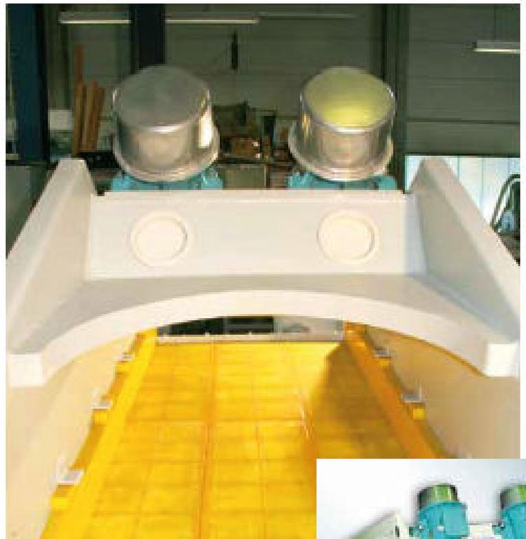
**ENTWÄSSERUNGSSIEBE** arbeiten in der Regel mit oben angeordneten Antrieben. Ausgeführt als Linearschwinger erreichen sie doppelte spezifische Siebleistungen gegenüber Plansieben. Die Ausführung des Siebes ist, je nach Anforderung, in Ein- oder Mehrdeckbauweise möglich. Foto: Aviteq
