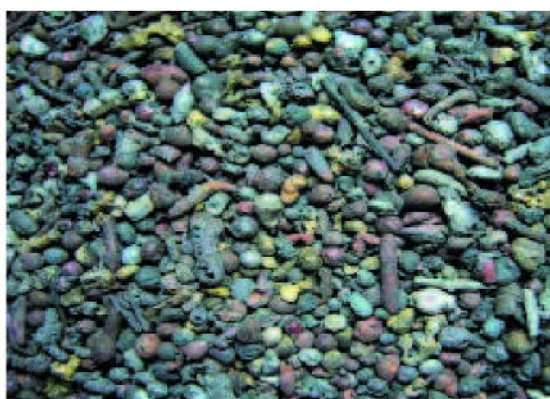
3b Metal residue separated from the dry discharge Aussortierte Metallrückstände aus dem Trockenaustrag Photos/Fotos (2): KEZO
