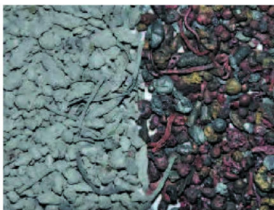
3a Comparison of metal residue from wet and dry discharge Vergleich Metallrückstände Nass- und Trockenaustrag
