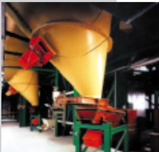
用于控制由多台电磁振动器驱动的双向电磁振动给料机时，可以非常轻松地通过设置控制器的主/从关系轻松实现切换功能。
