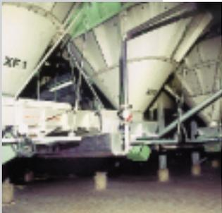
对于重型电磁振动管给料机，有时需要用到多个电磁振动器，此类数字化控制器可轻松实现两台振动器之间的同步。
